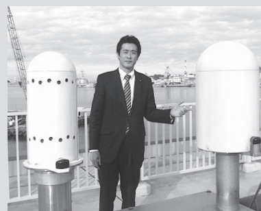
放射線を測定するモニタリングポスト 横須賀原子力艦モニタリングセンター
